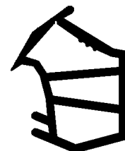
Rys. 12. Ościeżnice do drzwi GERDA W, GERDA WT, GERDA WD, GERDA WDT i GERDA WX 10 z uszczelką KA 2. Wygląd, przekroje i wymiary
